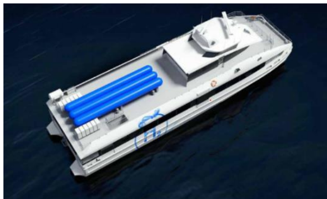
NY ENERGI: Hydrogen skal lagres på de blå tankene på skissen for fremtidens hurtigbåt. Fylkeskommunen i Sogn og Fjordane vil gjøre fylket til ledende på bruk av hydrogen som energi.
